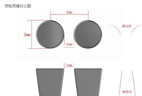
图 2 高效自清洁筛板和条缝筛板截面对比图
